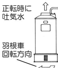
P I -10・P II -20(電源：3相 200V 用)のみ電気配線後、羽根車の回転方向が図の通りであるか、確認してください。(ポンプ銘板にも回転方向矢印があります)正しい回転であれば吐出口より空気や水が放出されますので、併せて確認してください。
