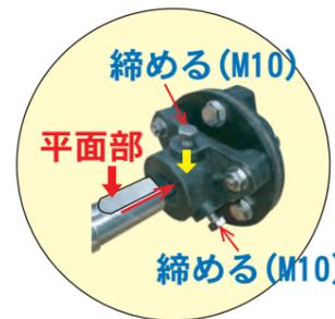
7. 羽根、ホイール組付品の2組をフロート間にくるようにセットし、軸受部に軸を挿入します。
